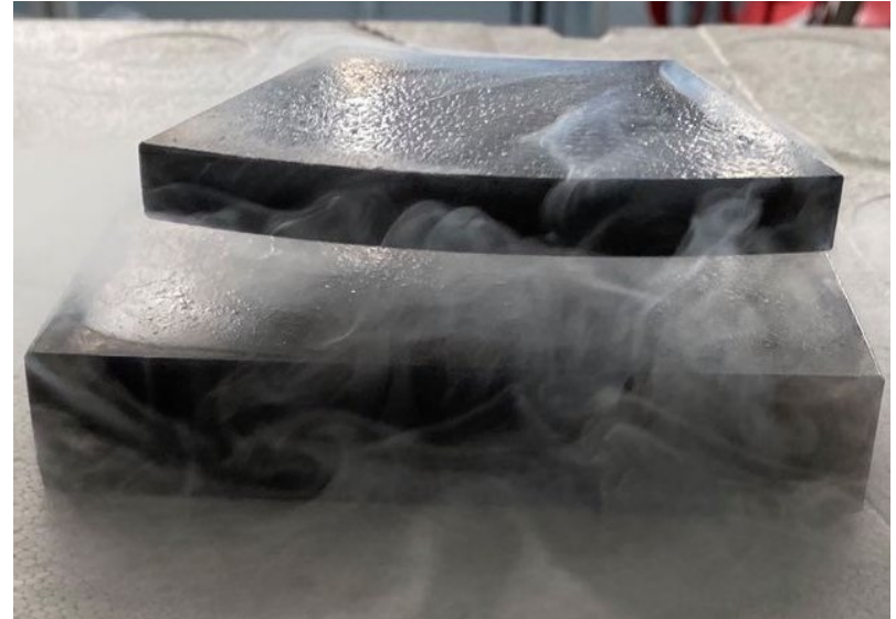
Lévitiation d'un massif supraconducteur commercial en GdBaCuO refroidi par de l'azote liquide au dessus d'un aimant permanent.
